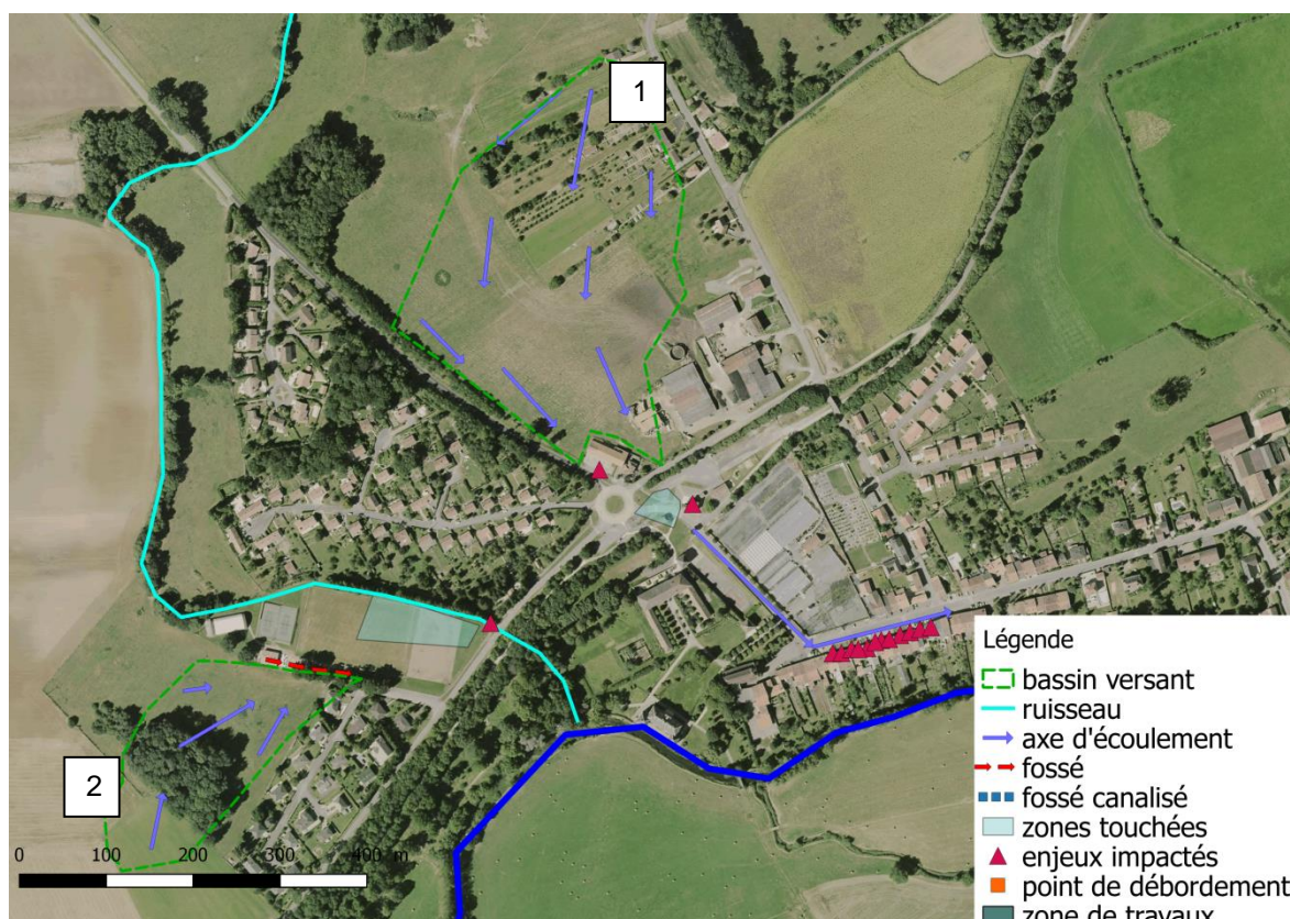
Fig. 1. Localisation des bassins versants problématiques de la commune de Pange
