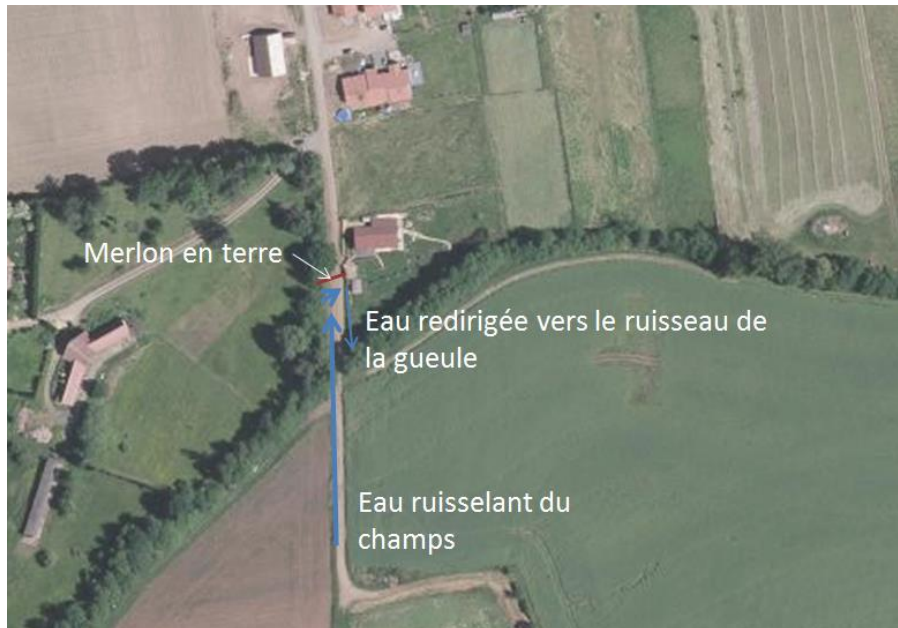
Fig. 8. BV n°2 – Localisation des ruissellements et du merlon aménagé en urgence sur le chemin d'Epange
