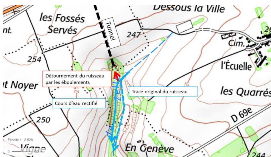
Fig. 3. Détournement du Rupt de Zelle (photos du cours d'eau dans la descente du talus de l'ancienne voie ferrée et du détournement du ruisseau par les éboulements)
